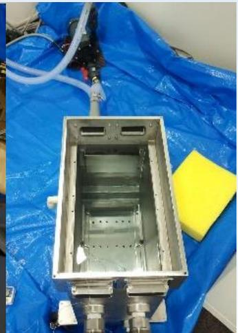
高沸点フッ化炭素を冷媒とした、社内での基礎実験の様子(2014年4月から5月に掛けて)
